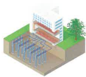
Pompe à chaleur sur sondes géothermiques
