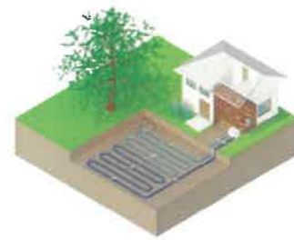
Pompe à chaleur sur capteurs enterrés horizontaux
