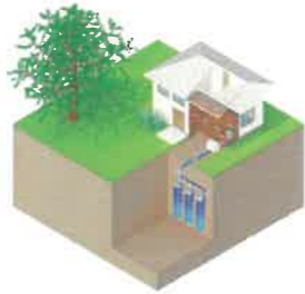
Pompe à chaleur sur corbeilles géothermiques
