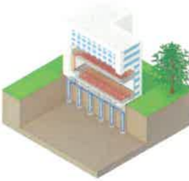
Pompe à chaleur sur géostructures énergétiques
